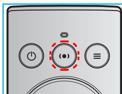
3. Bluetooth デバイスをプロジェクターにペアリング中、プロジェクターの Bluetooth LED インジケータは白色に点滅します。
