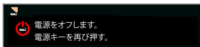
2. プロジェクターキーパッドの [P] またはリモコンの [O] をもう一度押して確認します。そうしないと、警告メッセージは、10秒後に消えます。プロジェクターキーパッドの [P] またはリモコンの [O] を2回押すと、プロジェクターがシャットダウンします。
